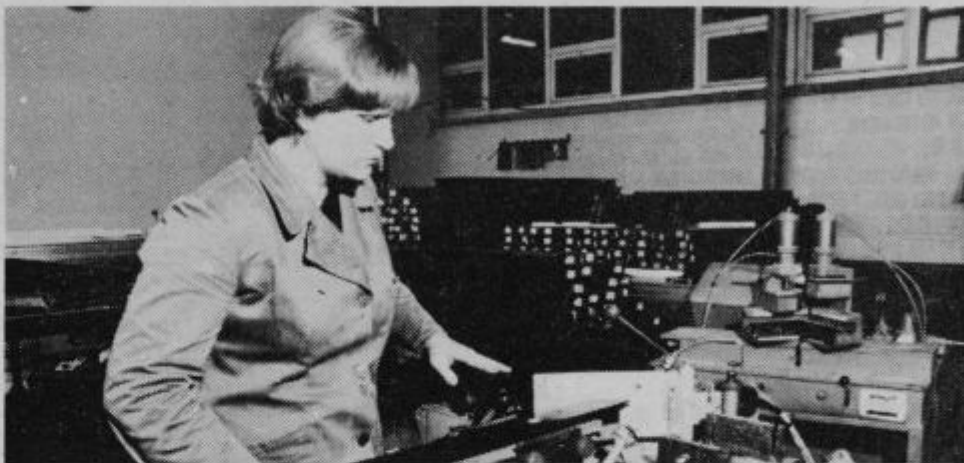
Detajl iz proizvodnje tozda plastika Kostroj – varenje PVC okvirjev za izdelavo stavbnega pohištva
