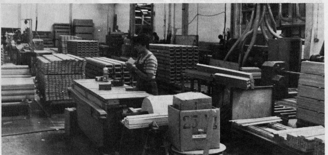
Priprava in embalaranje elementov suhomontažnega podboja. — Foto: Ažman
