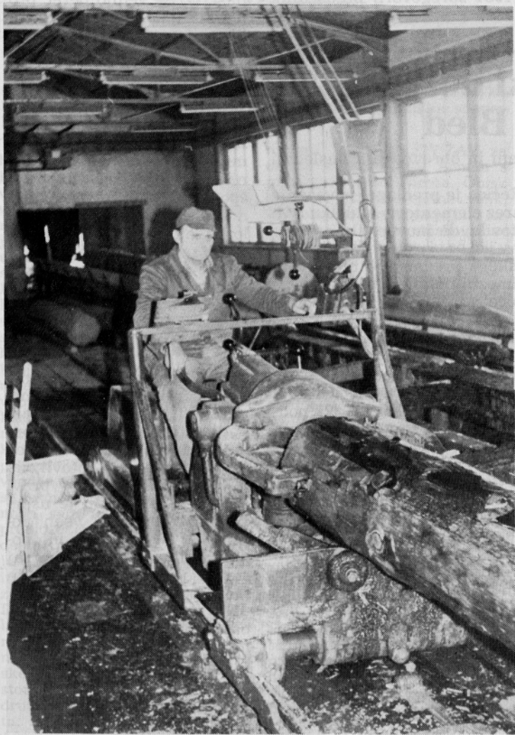
Pravilni napon za žaganje oblovin in neodstopanje od pravih dimenzij žagovcev je pogoj za boljše izkoriščanje surovine
