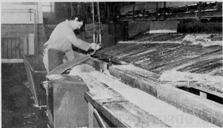
Strokovno krojenje — čeljenje žaganega lesa je pogoj za izplen čimvečjih količin lesnega gradiva
