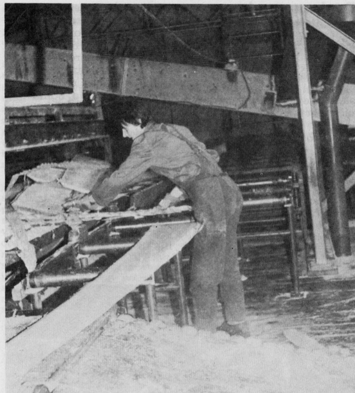
Strokovno razvrščanje žaganega lesa za robljenje in čeljenje je pogoj za pravilno obdelane žagovce
