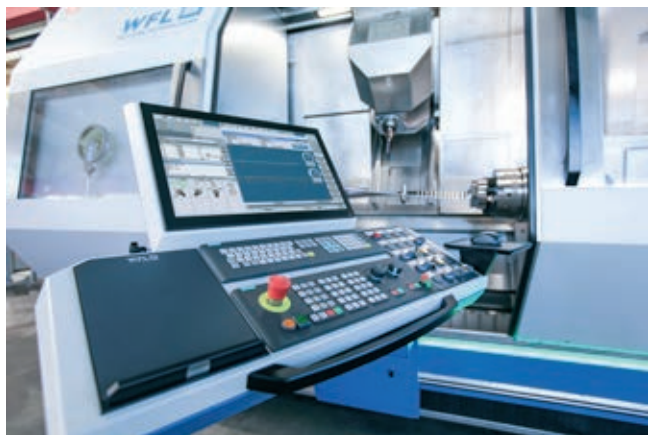
» WFL iControl zagotavlja povečano zanesljivost preko stalnega spremljanja operacij obdelave. Vir: WFL Millturn Technologies
