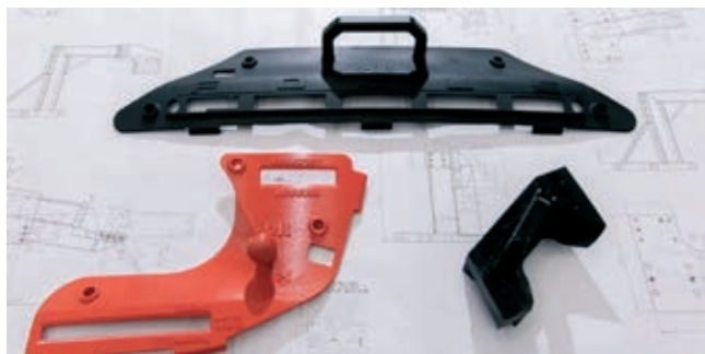
» Različne 3D-natisnjene šablone, orodja in montažni pripomočki, ki jih je razvila pilotska tovarna Ford.
