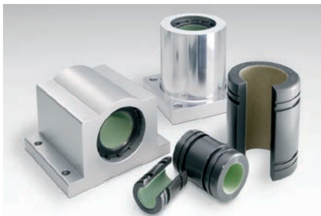
» Za določene aplikacije, predvsem tiste, ki so težavno ali nevarno dostopne za rutinsko vzdrževanje ali se nahajajo v zelo kontaminiranih okoljih, so ležaji, ki se sami mažejo, idealna izbira. | Vir: Thomson Industries
