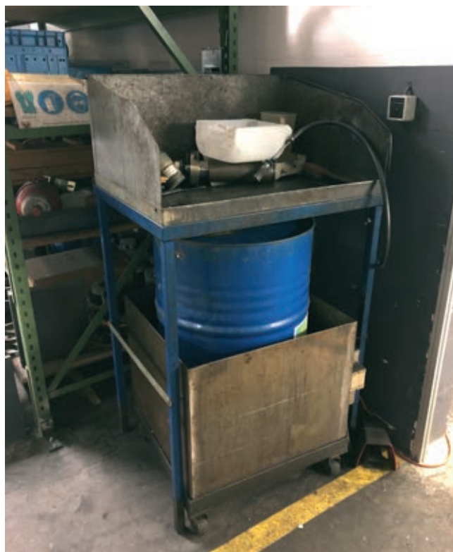
» Pralne mize s čopiči so omejene pri grobi umazaniji in zapletenih oblikah kosov.
