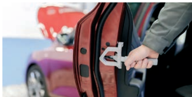
» Na enem modelu vozila uporabljajo več kot 50 prilagojenih orodij, ki so izdelana s 3D-tiskom.
