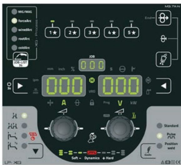
» Krmilni sistem EWM LP-XQ za večstopenjski vir varilnega toka Titan XQ puls MIG/MAG
