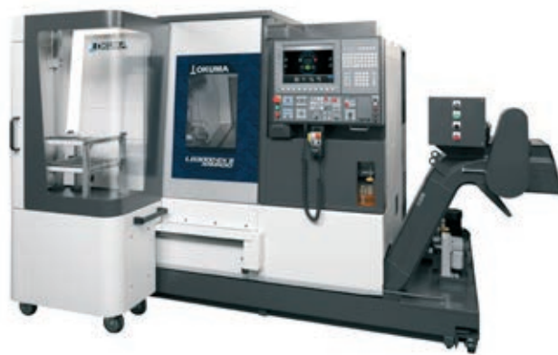
» Sistem ARMROID v kombinaciji z zalogovnikom za obdelovance omogoča enostavno avtomatizacijo. Vir: Okuma
