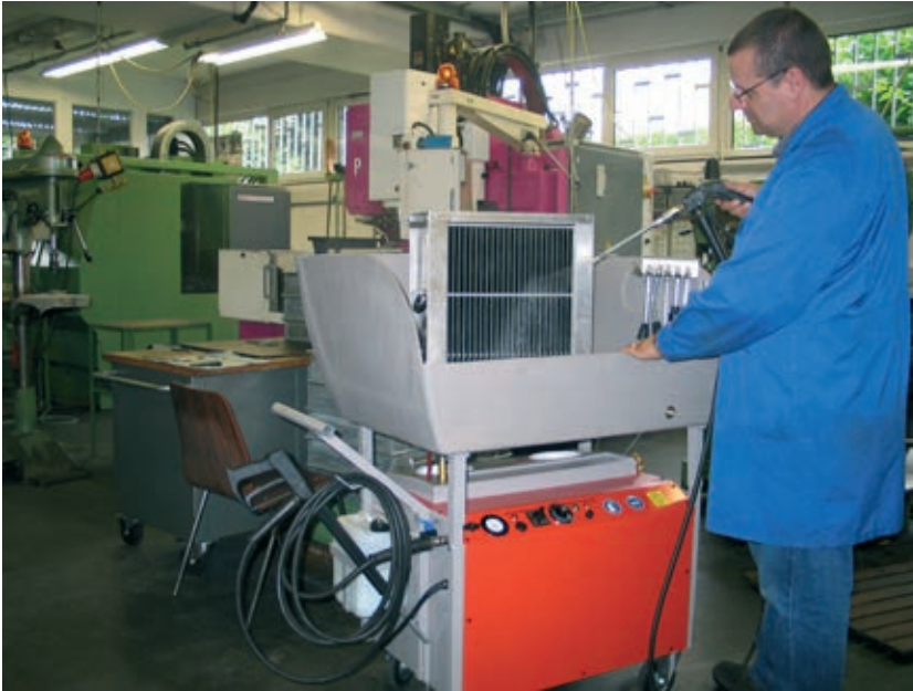
» Vzdrževanje naprave z nizkotlačno napravo za čiščenje z vročo vodo: postopek je učinkovit in nežen, nečistoče pa se ne razpršijo po tovarniški hali.
