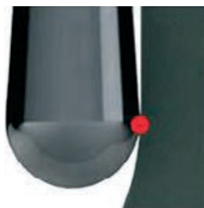
» AE-LNBD-H krogelni utorni rezkar točkovno nalega na obdelovanca
