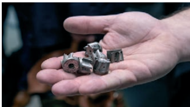
» Čelna frezala izdelana s postopkom 3D-tiskanja in dodelana z lasersko obdelavo v Kometovem obratu na lokaciji podjetja v Stuttgart-Vaihingenu. Vir: Ceratizit
