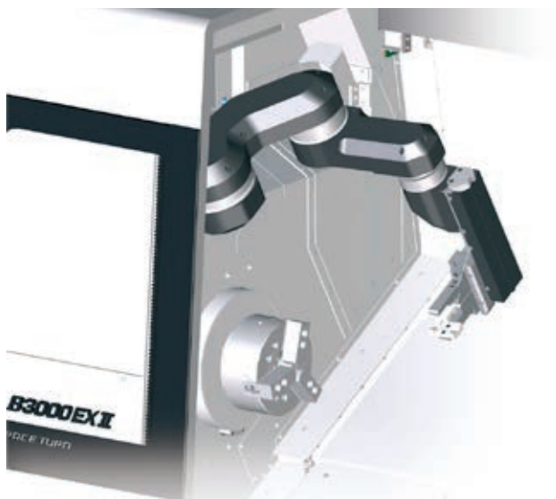
» Robotska roka sistema ARMROID podaja in odstranjuje obdelovance, podpira obdelovance med procesom obdelave ter izboljša obvladovanje odrezkov. Vir: Okuma
