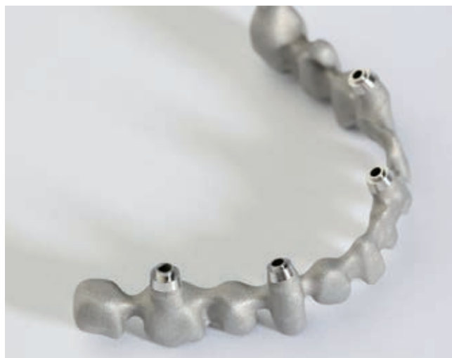
» Zobni mostiček izdelan s postopkom 3D-tiskanja, ki je posebej prilagojen določenemu pacientu z rešitvijo naknadne obdelave. Vir: GF Machining Solutions
