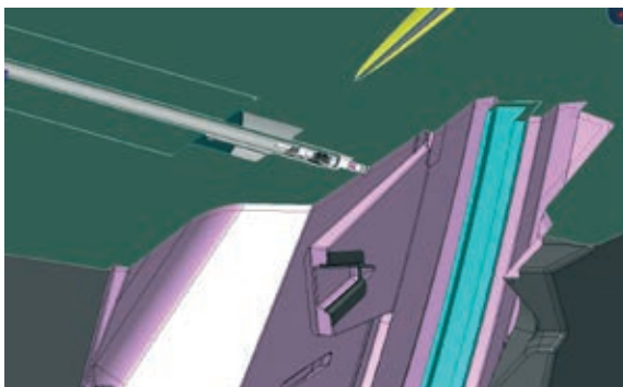
» Slika 2: Vgradnja tlačnega senzorja v orodje za brizganje dekorativne zaslonke
