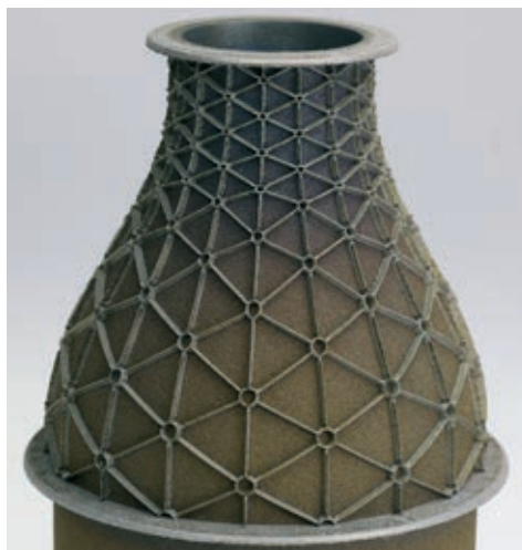
» Turbinska šoba za letalsko industrijo izdelano z aditivno proizvodnjo. | Vir: OPEN MIND
