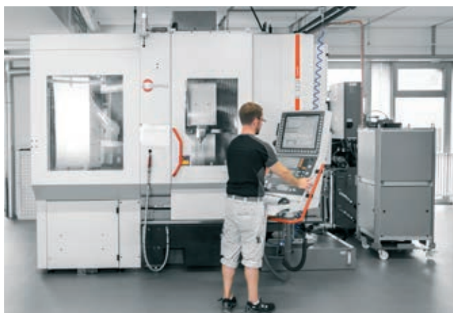
» V podjetju Medartis AG frezajo titanove ploščice za osteosintezo na obdelovalnih centrih proizvajalca Hermle. Vir: Hermle
