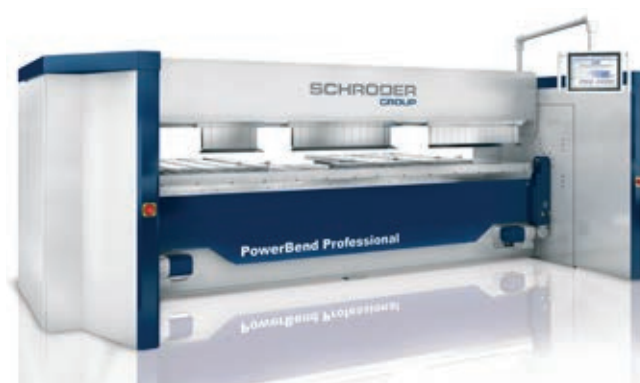
» Krivilni stroj PowerBend Professional se lahko uporablja kot industrijski stroj za krivljenje tanke pločevine ali kot krivilni stroj v vrhunskih obrtniških delavnicah. Vir: Schröder Group
