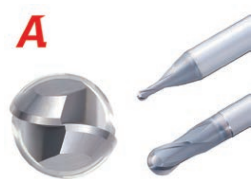
» AE-BM-H štirirezni krogelni rezkarji za grobo in polfino rezkanje kaljenih jekel.
