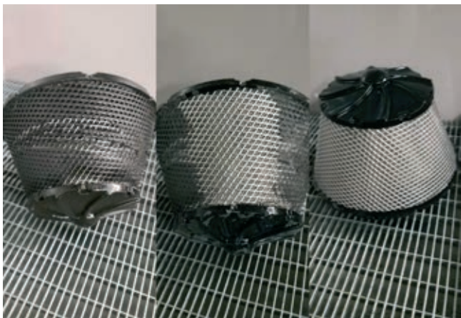
» Primer koničnega filtra: očiščeno z nizekotlačno napravo z vročo vodo – pred postopkom in po njem v najkrajšem možnem času
