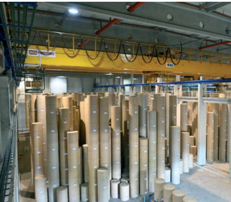
» Dvigala v skladišču rol papirja podjetja Palm so nenehno v uporabi. To je tudi razlog, da podjetje Konecranes izvaja študijo zanesljivosti dvigala, da odkrije znake obrabe. | Vir: Konecranes
