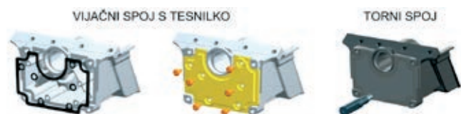
» Slika 3: Prikaz vijačnega spoja s tesnilko in izvedbe spoja z varjenjem z gnetenjem (Avtor: Dino Grbič)
