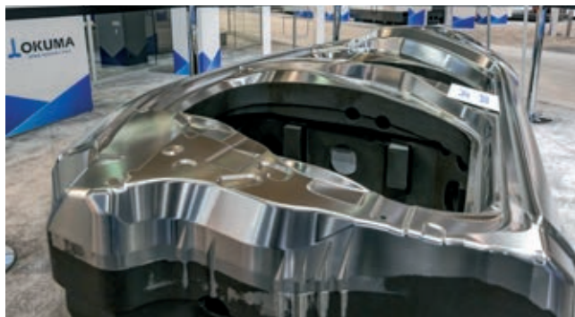
» Avtomobilsko orodje za preoblikovanje izdelano na obdelovalnem centru MCR-S proizvajalca Okuma. Vir: Okuma
