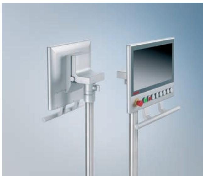
» Slika 1: Primer panela, nameščenega na vrtljivi roki, z vgrajenimi gumbi in ročajem.
