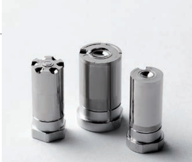
» Lasersko teksturiranje površin orodij za brizganje leč kompaktnih modlov kamer, ki imajo bistvene lastnosti lovljenja svetlobe. Vir: GF Machining Solutions
