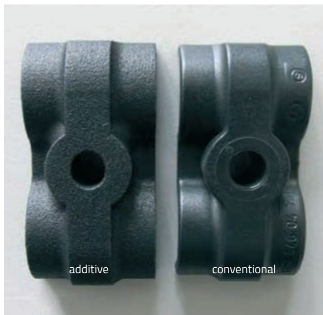
» Reinženirstvo rezervnih delov za Daimler Buses (Vir: EOS GmbH)
