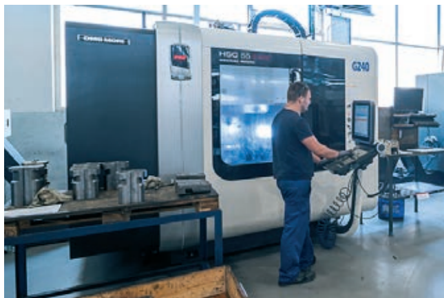
» Obdelovalni stroj HSC 55 linear med natančno in učinkovito obdelavo kompleksnih orodij za proizvodnjo steklenic. Vir: DMG MORI. Foto: Jens Ellensohn
