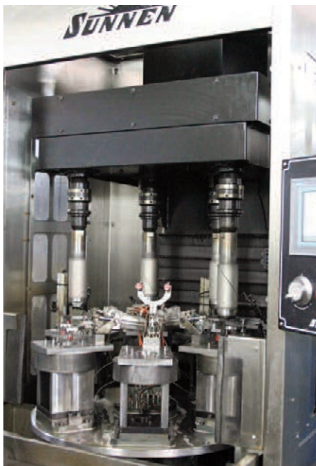
» Stroj za honanje VSS-2 s štirimi vreteni, ki ga uporablja podjetje Cloyes Gear za honanje izvrtin VVT statorjev. Sredinska luknja VVT statorja izdelana z metalurgijo prahov je s honanjem dokončana do okroglosti 50 mikronov in skupne tolerance 80 mikronov.
