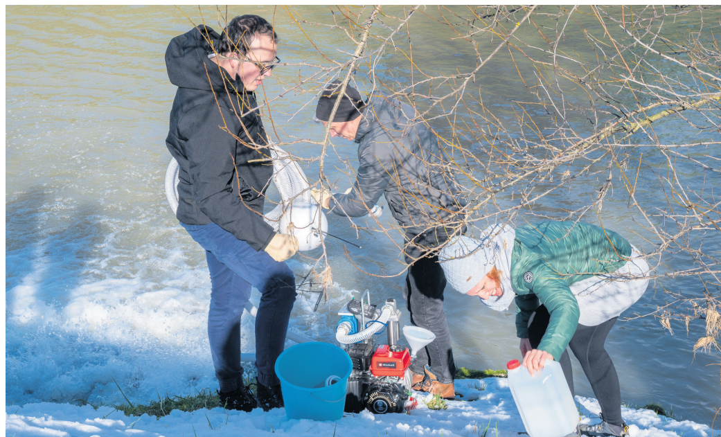
Na fakulteti za varstvo okolja so razvili vzorčevalnik oziroma prototip, ki temelji na filtrirnem sistemu vakuumske črpalke in omogoča precej hitro in učinkovito vzorčenje večje količine vode. Na fotografiji je dr. Anja Bubik med delom. (Foto: arhiv fakultete)
