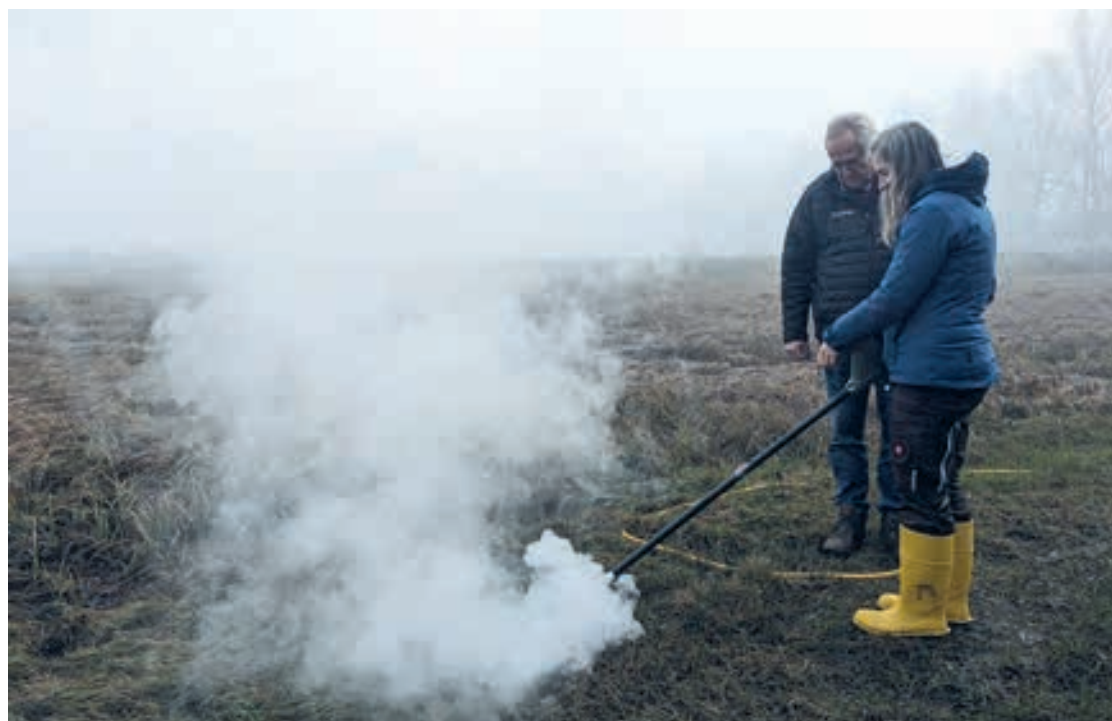
Naprava s pomočjo električnega toka povzroči uničenje rastline, vključno z njenimi podzemnimi deli. (Foto: Ana Tratnik)
