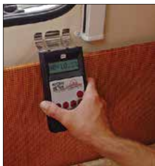
Test vodotesnosti (vlažnost sten) počitniških vozil
