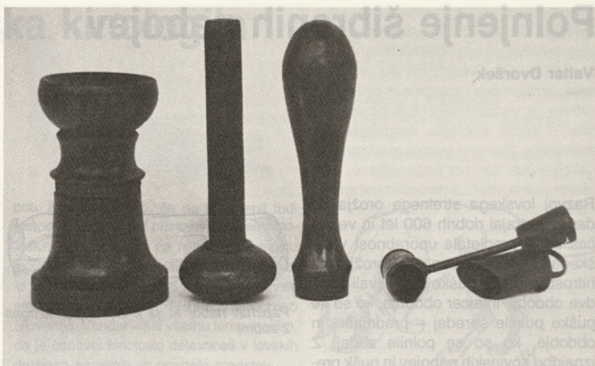
Leseni kalup ali rekalibrator, leseni ročaj za nabijanje čepov in poklopca, leseni ročaj za robljenje na spodnjem koncu, izrezan posebej za sled tulca. Z vrtenjem ročaja se je naboj zarobil; bakrena merica za smodnik in bakrena merica za šibre.
