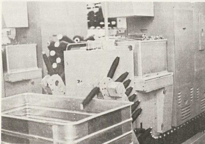
Pri predilnem stroju v predilnici IV. nadomešča snemalke avtomatska naprava.
