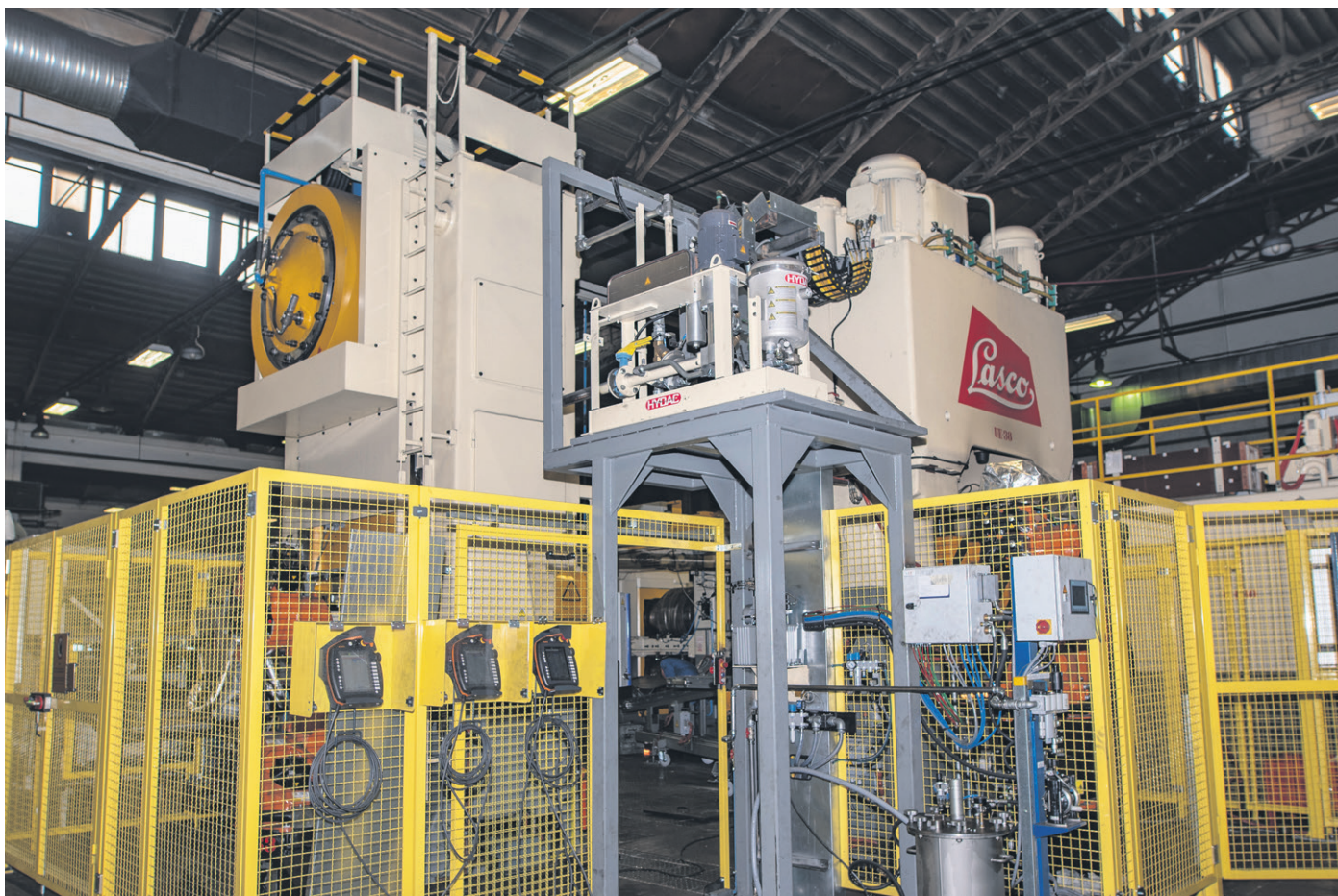
Prva robotizirana linija v Uniorjevi kovačnici je namenjena kovanju ojníc za motorje osebnih vozil. Naložba je bila vredna približno štiri milijone evrov in ko bo linija začela polno obratovati, bodo v tovarni z njo na mesec lahko izdelali najmanj 400 tisoč ojníc.
