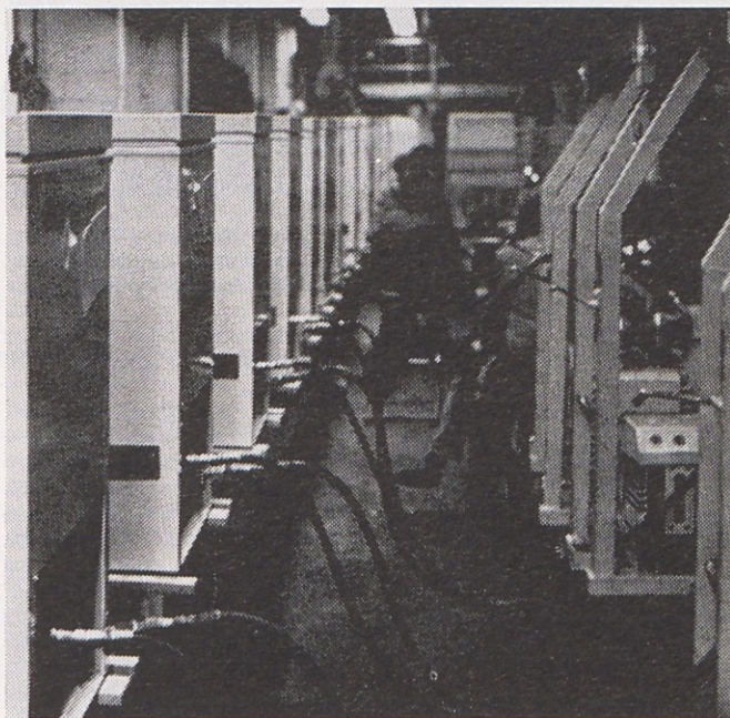
Vakuimiranje – priprava hladilnega sistema za polnjenje s hladilno snovjo – freonom
