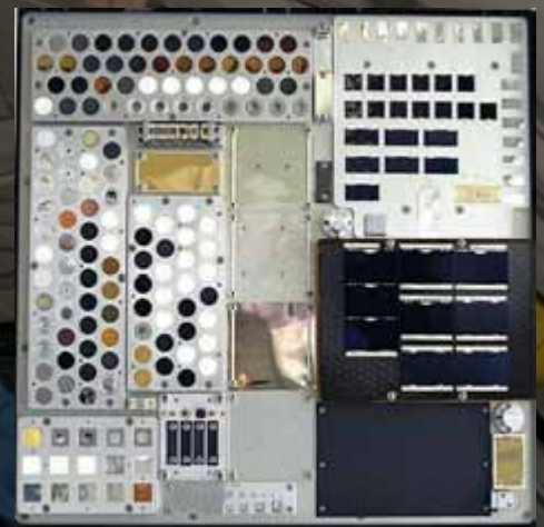
Oprema za preizkušanje vpliva mikrogravitacije na različne materiale NASA
