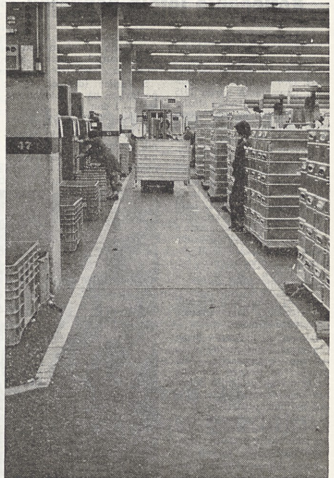
Označene transportne poti zagotavljajo varno vožnjo voznikom villičarjev in samim posluževalcem strojev
