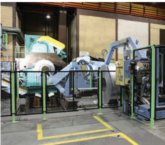
» Navijalec za pločevino, voziček za kolote in stroj za privezovanje kolotov. | Vir: Unitechnik Automatisierungs
