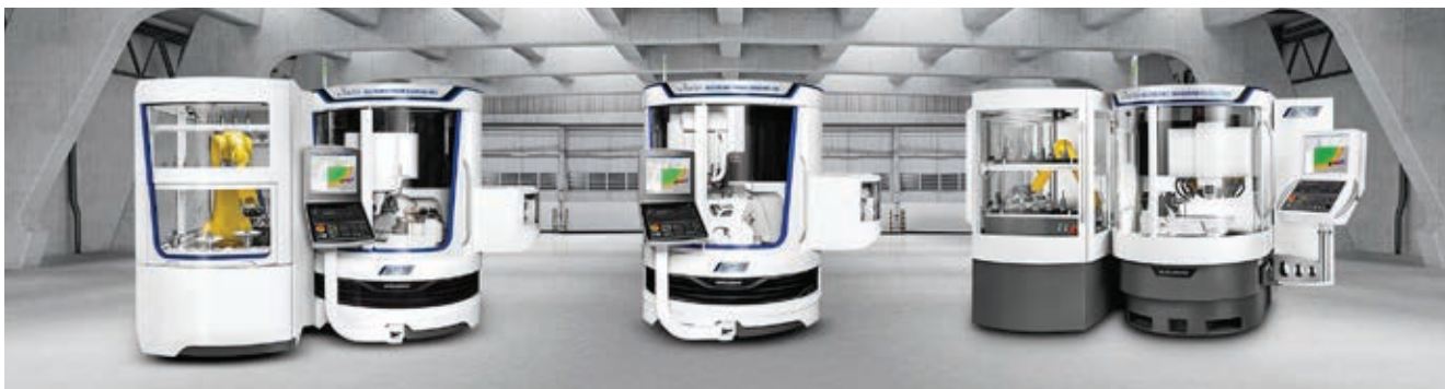
» Nabor strojev podjetja WALTER s konceptom dva v enem. Od leve proti desni: HELITRONIC VISION DIAMOND 400 L, HELITRONIC POWER DIAMOND 400, HELITRONIC DIAMOND EVOLUTION
