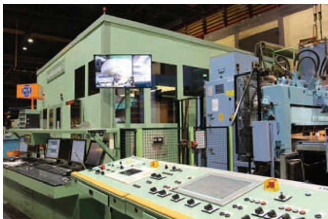
» Pogled z operaterjeve komandne plošče z vgrajenimi zasloni na dotik na stroj za naoljevanje pločevine in postaje za pregledovanje. | Vir: Unitechnik Automatisierungs
