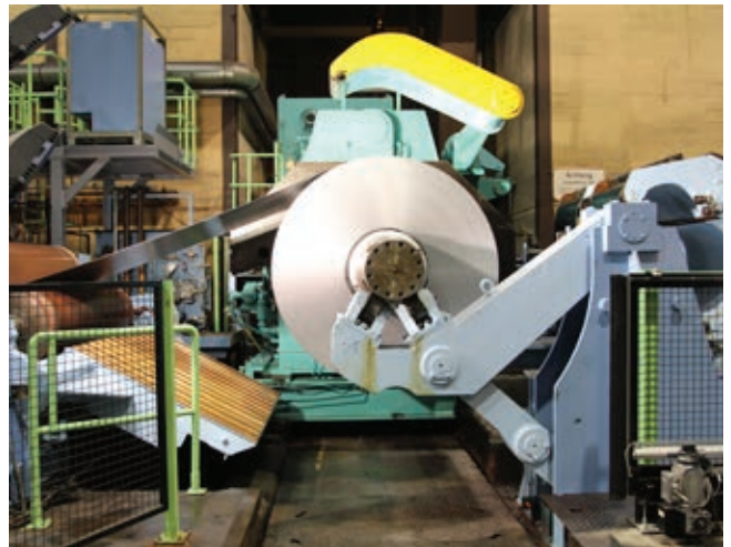
» Drsna vrata, ki ločujejo dve varnostni območji na navijalcu pločevine. | Vir: Unitechnik Automatisierungs
