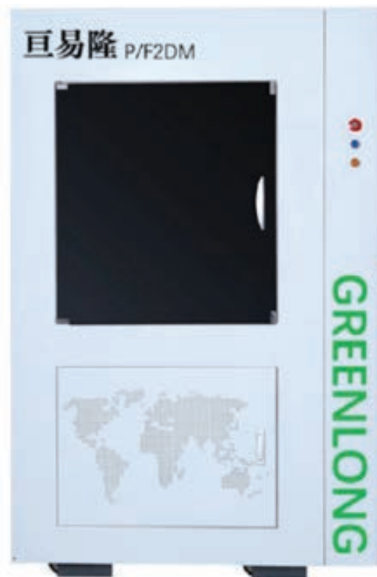
» Greenlongov P/FFDM 3D-tiskalnik, kovinski sistem AM, ki temelji na tehnologiji MIM
