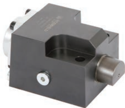
» Slika 1: Za novo zagozdno vpenjalo za vpenjalna orodja na stiskalnicah in strojih za brizganje ni potrebna stalna hidravlična oskrba. (Slika: ROEMHELD).
