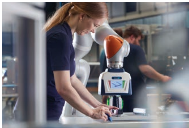
» Na hannovrskem sejmu bo podjetje SCHUNK prikazalo, kako se lahko elemente tehnološke platforme SCHUNK Co-act JL1 vgradi v standardno prijemalo. S silo prijemanja 450 N bo podjetje SCHUNK postavilo nove mejnike na področju kolaborativne manipulacije. | Vir: SCHUNK
