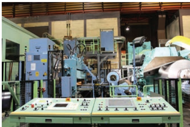
» Izhod iz stroja za naoljevanje na navijalec pločevine. | Vir: Unitechnik Automatisierungs
