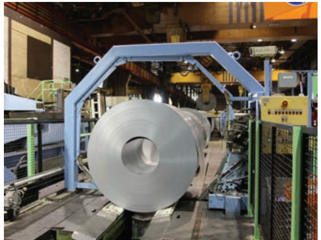
» Transportni sistem in stroj za privezovanje kolotov. | Vir: Unitechnik Automatisierungs
