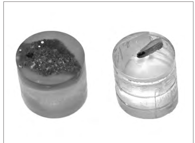
Obrušena in spolirana vzorca ometa in barvnih plasti v poliestrski smoli. Foto: Irena Potočnik, 24. 3. 2016.
