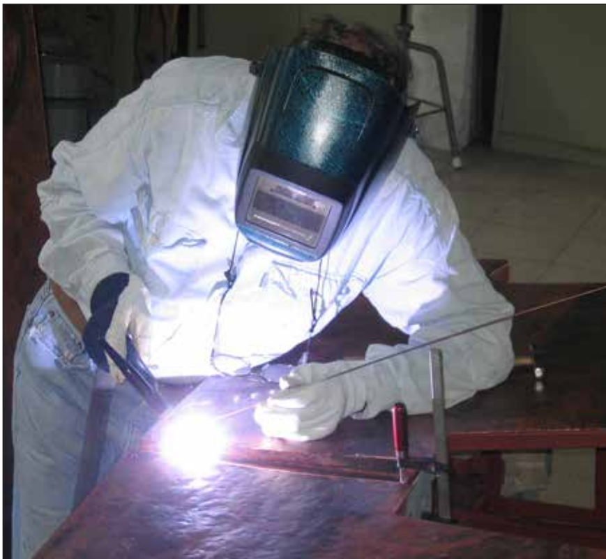
Ročno obločno varjenje z oplaščeno elektrodo in varjenje TIG, ki je prikazano na sliki, je danes v razvitem svetu še vedno močno prisotno.
