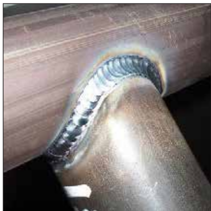
Slika 3. Ročno varjen priključek cevi na cev po postopku TIG utripno, brez obrobnih zajed, visoke kakovosti in legega videza
