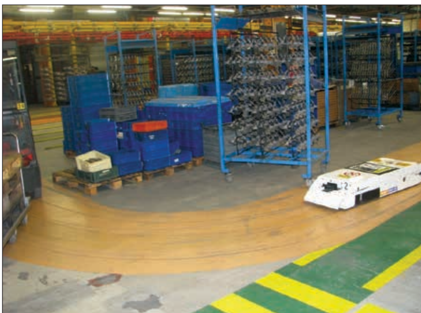
Sistem AGV-naprav (automated guided vehicle – avtomatsko voden viličar) v podjetju TPV Velika Loka
