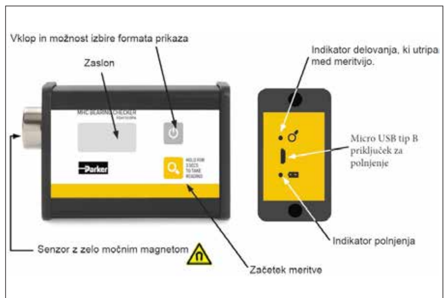
Slika 2. Sestavni deli naprave MHC Bearing Checker
