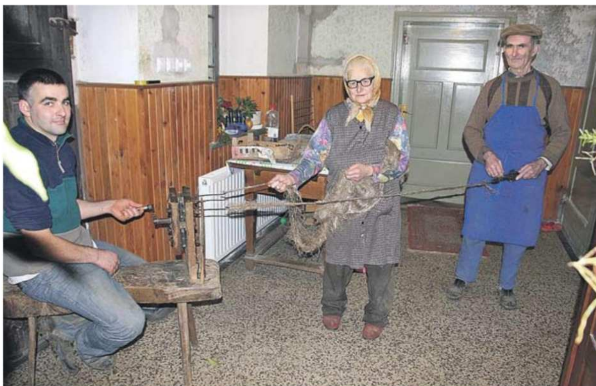
Pletenje vrvi na stroju, imenovanem »brde«. Poganja jih sin Zvonko, mama Marije prede, oče Matija pa drži vrvice ob spletnju vrvi.
