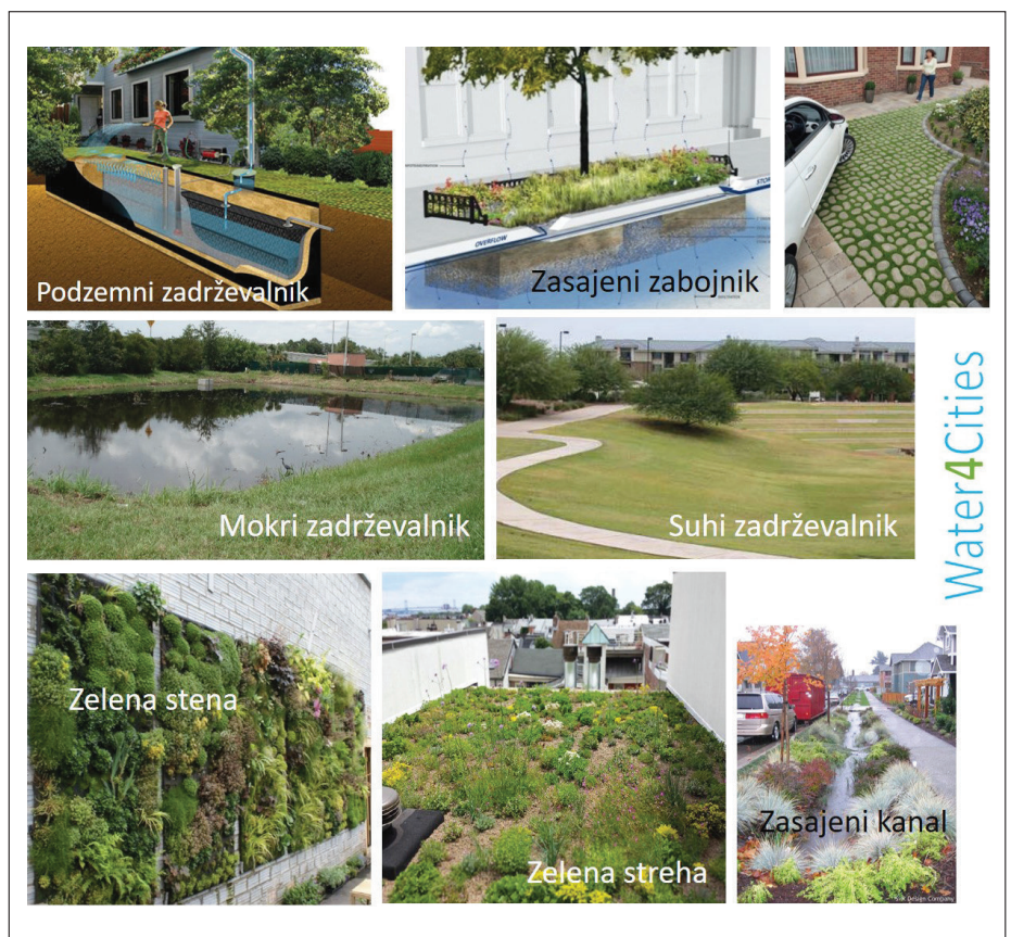
Slika 1 • Nabor primerov urbanih sonaravnih ukrepov za upravljanje padavinskih voda (prirejeno po (Kofinas, 2019)).
