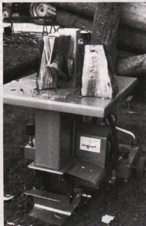
Na gradbenem sejmu v Gornji Radgoni smo se predstavili tudi z univerzalnim cepivnikom za drva, ki je proizvod delavcev TOZD Mehanizacija. Z njim je možno cepiti tudi drva do dolžine 110 cm. Foto: Vili Šuster
