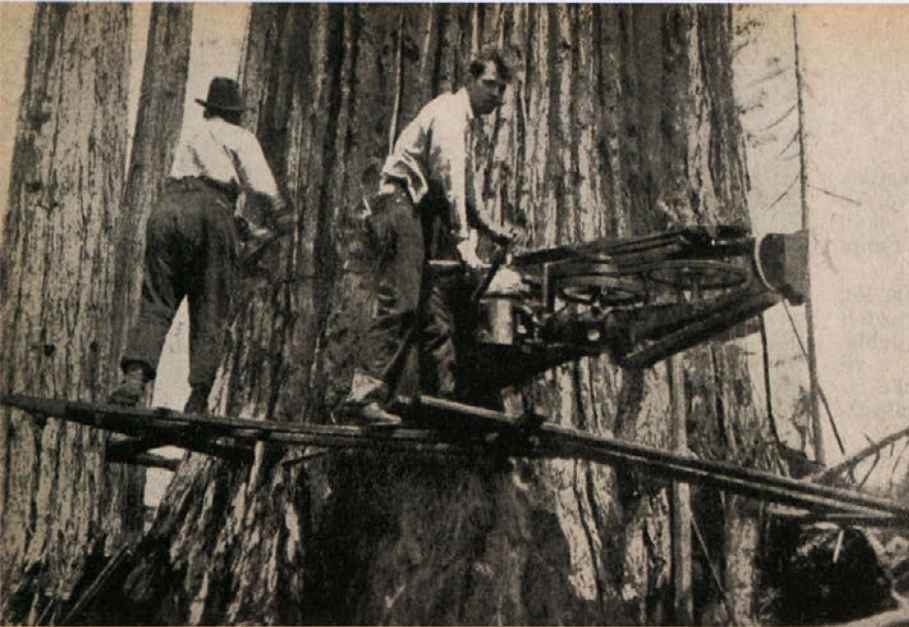
Delavci se lotijo takega velikana s krožno žago na plinski motor. Kljub temu pa se mučijo po ves dan, preden ga poderejo
