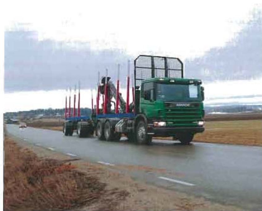
Gozdarsko vozilo SCANIA P124CB6X4NZ 400 KM z avtodvigalom znamke JONSERED in prikolico NARKO
