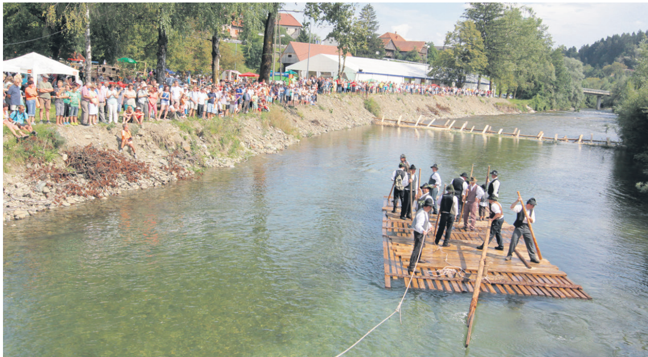
Nekoč sta 16- ali 20-metrski splav dva splavarja morala sestaviti v osmih urah, tega 11-metrskega pa so s skupnimi močmi sestavili v šestih urah. Tvori ga 32 vrst pet- in šestmetrskih tramov.
