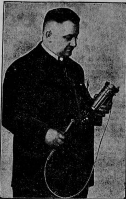
Aparat, ki v rudnikih takoj javi strupene pline. Aparat, ki ga je iznašel bielefeldski inženier Nellisseu, je že preizkušen.
