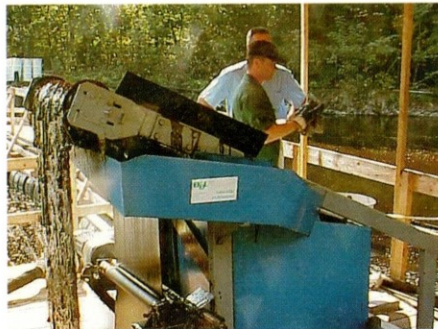
Posnematna naprava zbira in filtrira plavajoče odpadke in oljno emulzijo
