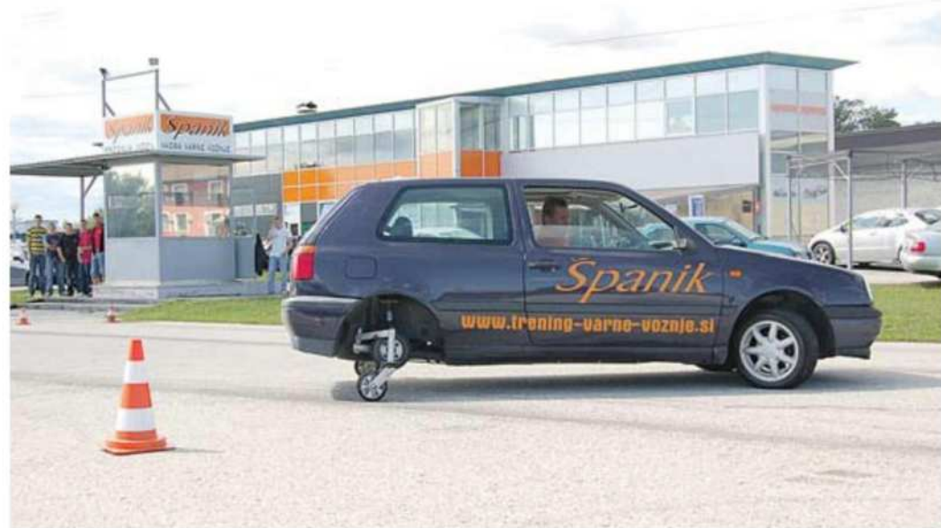
Na treningu se s posebej predelanim avtom simulira zanašanje med vožnjo.
