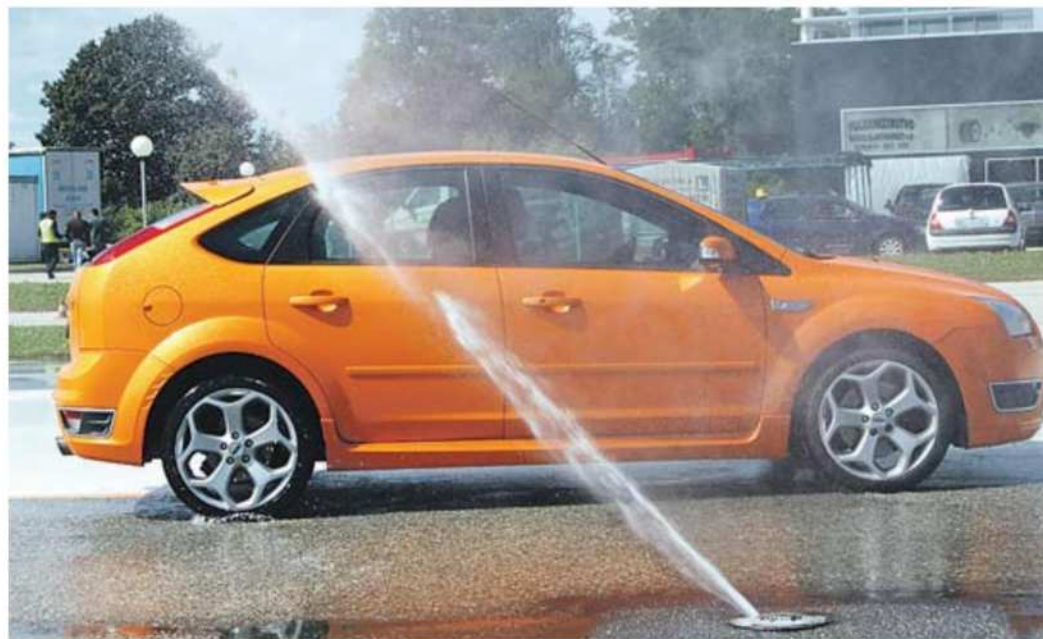
Vodna zavesa omogoča ugotavljanje reakcijskih časov voznikov.
