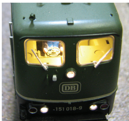
Razsvetljena notranjost strojevojske kabine in osvetljen komandni pult se lahko prižigata in ugašata ločeno. Sprednja strojevojska kabina je opremljena s figuro strojevodje, dodatki, kot so držala na kabini in brisalci, pa so serijsko vgrajeni.
