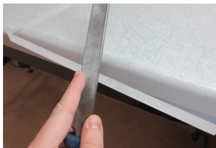
Robovi plošče iz akrilnega stekla so lahko zelo ostri, zato jih obdelamo s pilo.
