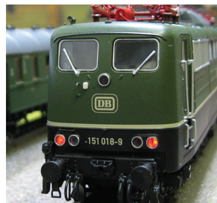
Pri menjavi smeri vožnje se na zadaj vozeči kabini v zunanjih spodnjih dveh žarometih prižgejo rdeče luči oziroma rdeče svetleče diode.
