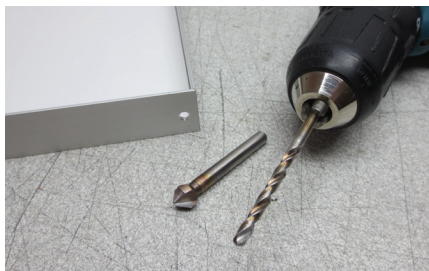
Robove izvrtine za priključni kabel posnamemo z rezkarjem.
