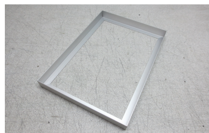
Pri razrezu profila pod kotom 45° moramo biti zelo natančni.
