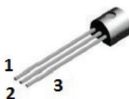
Priključki LM78L05 (1 – vhod, 2 – GND, 3 – izhod)
