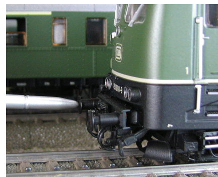
Odbojniki so vzmeteni in imajo nekaj mm hoda.
