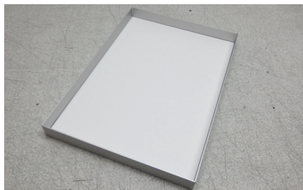
Plošča forex bo ob natančnem razrezu ohranjala pravokotno obliko okvirja.
