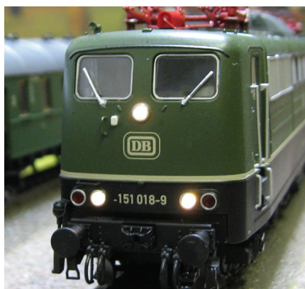
Žarometi na modelu delujejo zelo prepričljivo. Za prve žaromete so vgrajene toplo bele svetleče diode.
