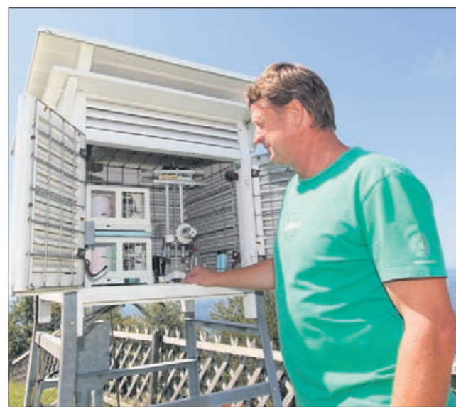
Dežurni meteorološki opazovalec, ob našem obisku Jože Senica, vsako uro natančno popiše podatke in odčitavanja meteorološke hišice ter drugih naprav in jih sporoči agenciji za okolje.
