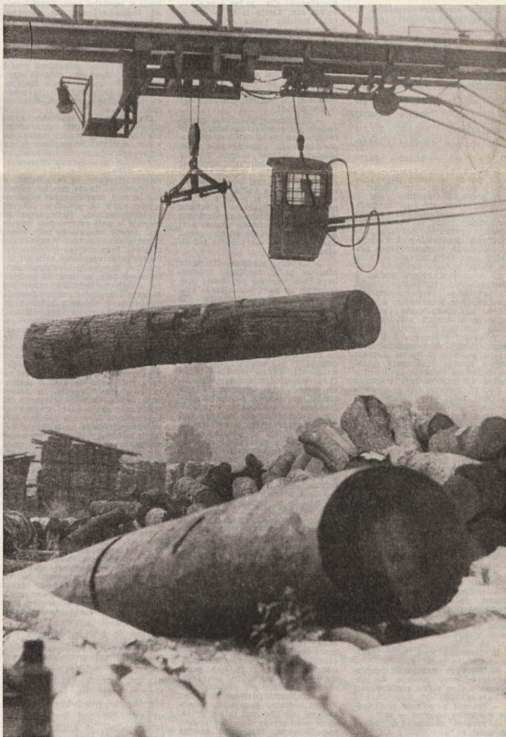
Pettonski portalni žerjav na žagi v Škofljici igraje dvigne še tako velik kos debla in ga potem brez težav prenese daleč na drugo stran obrata
