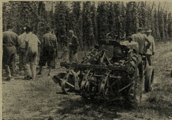
Osipalni plug, kombiniran s kultivatorjem — priključek na traktorju Steyr 18 KS med preizkušnjo v hmeljišču Inštituta
