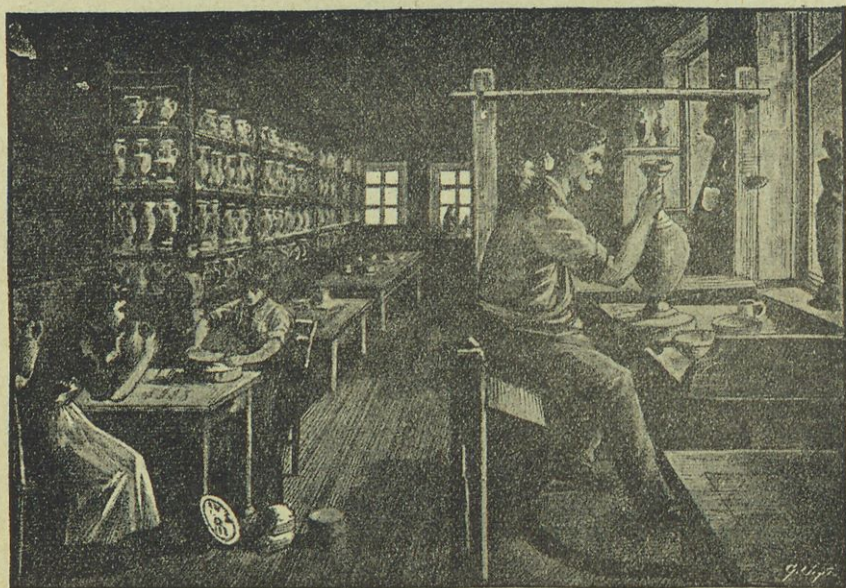
Slika 41. Oblikovalnica v porcelanski tvornici. Na desni delavec pri lončarski plošči, na levi oblikovanje v oblikah iz mavca.
