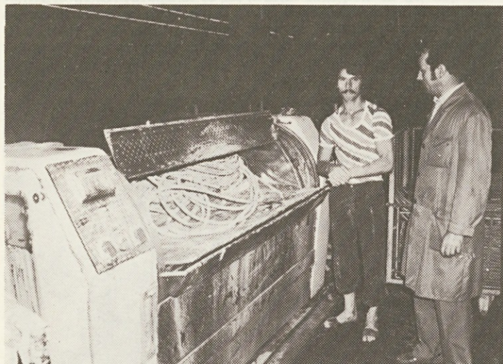
Inovacija Jožeta Klemenčiča na pralnem stroju za pranje brizganih izdelkov je velika pridobitev pri varstvu okolja.
