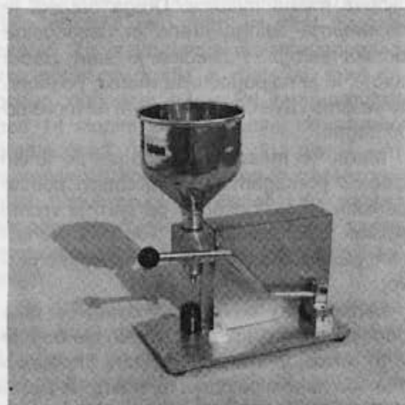
Dozirna naprava za matični mleček je narejena iz specialne pločevine, ki ne reagira na kisline v mlečku.
