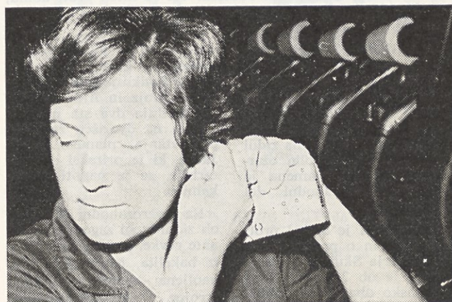
Zaradi povečanega hrupa v oddelku sukalnice morajo posluževalke strojev uporabljati stekleno vato ali ušesne čepke. Na fotografiji vidimo previjalko, kako si namešča vato.
