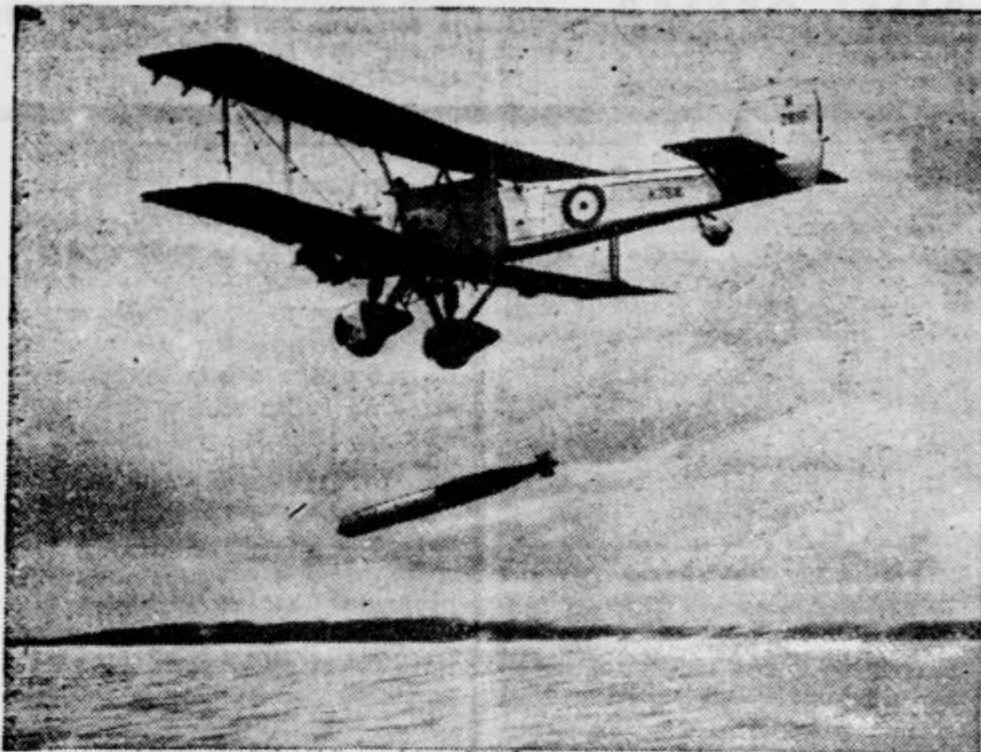
V Gosportu pri Portsmouthu je angleška admiralteta dala preizkusiti posebno letalo, ki je za poskus odvrlo 1500 kg težak torpedo
