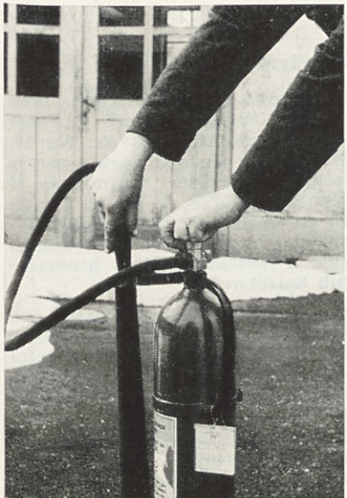
Odpremo ventil in snamemo cev z ročnikom...
