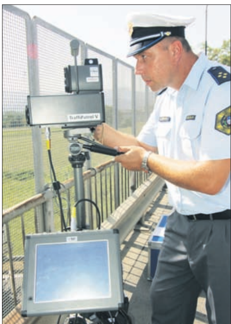
Pri ročnem načinu merjenja hitrosti je naprava usmerjena proti vozilu, meritev pa se sproži s pritiskom na sprožilec. Šest slik, ki se prikažejo na zaslonu, se nato shrani na pomnilniško kartico.
