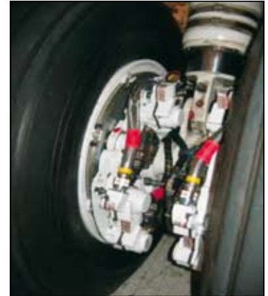
Slika 4. Električna zavora in njena namestitvev (proizvajalec Goodrich)
