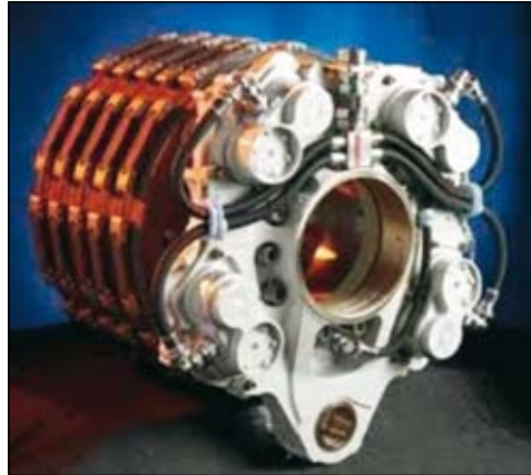
Slika 4. Električna zavora in njena namestitvev (proizvajalec Goodrich)
