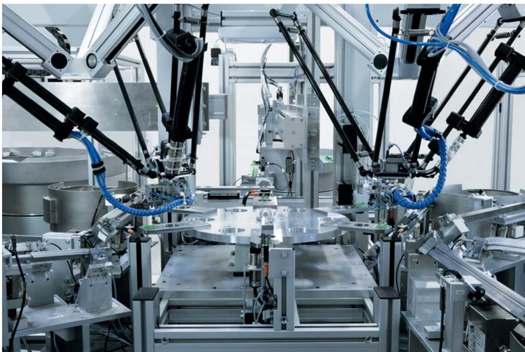
Izredno lahek Tripod EXPT s posebno palično kinematiko je sestavljen iz standardnih elektromehanskih sestavin in ultralahkih karbonskih palic, ki zagotavljajo učinkovito uporabo pogonske tehnologije. (Foto: Festo)
