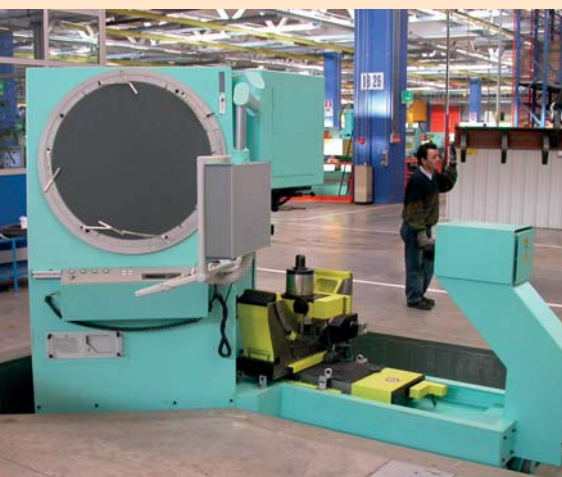
Slika 7: Postavitev profilnega projektorja po naročilu podjetja Avio. Posebnost tega stroja je njegova vgraditev v betonske temelje za večjo točnost.
