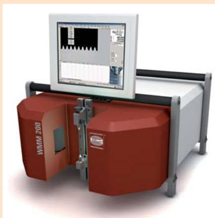
Slika 1: Stroj za dvodimenzionalno merjenje gredi. Meritev in poročilo o meritvi izvede v 2 sekundah.
