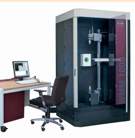
Slika 2: Multisenzorski stroj za merjenje gredi. Trenutno edini stroj na svetu, ki omogoča hkrati optične in dotikalne meritve gredi.
