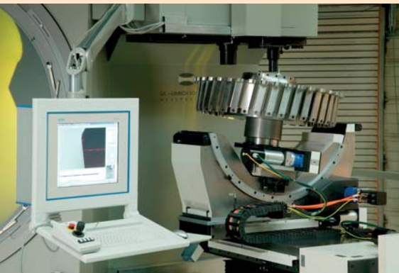
Slika 6: Merilni projektor, izdelan po naročilu in zahtevah vodilnega vesoljskega in letalskega podjetja General Electric. Vodstvo podjetja je izrecno zahtevalo, da ta projekt izpeljejo strokovnjaki podjetja Schneider.
