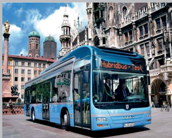
Hibridna rešitev za mesto: prvi mestni hibridni avtobus v Münchnu (proizvajalec MAN) porabi 30 odstotkov manj goriva kot konvencionalni.
