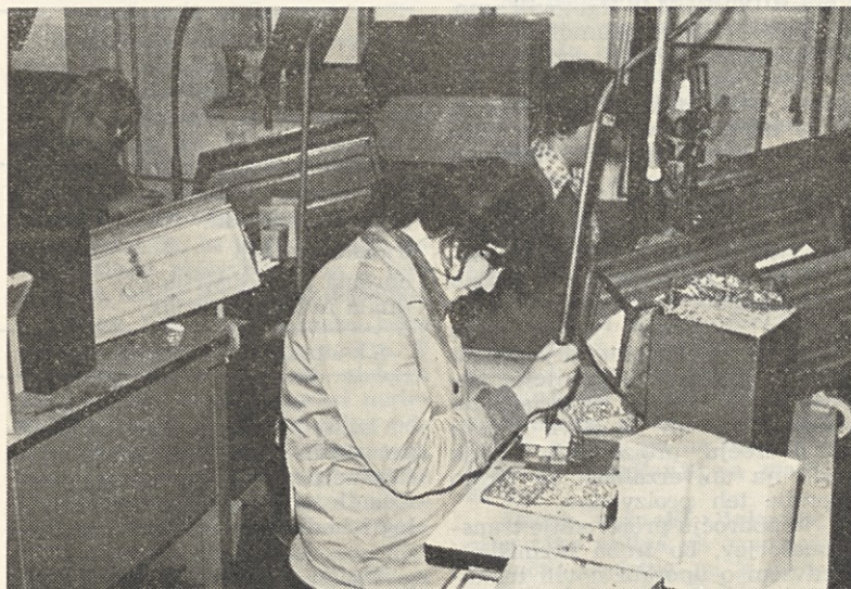
Danes še tako — jutri pa polavtomatizirana operacija privijanje krepeljcev na mikro stikala
