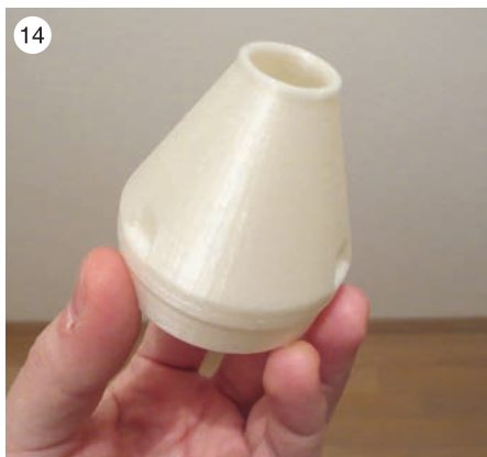
14 Na sliki se vidi, da je površina izdelka stopničasta, okroglina adapterja pa ni povsem okrogla, ampak bolj mnogokotna.
