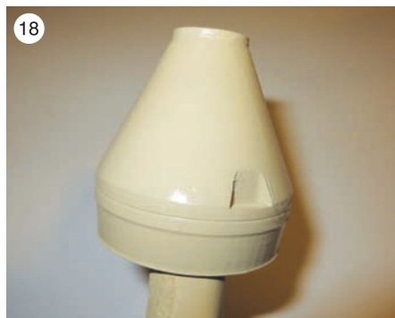
18 Pri drugem sloju je najbolje uporabiti kit v pršilki, ki bo prekril manjše neravnine, boljše vidne pa bodo ostale večje napake, ki jih lahko pozneje popravimo z dodajanjem kita v manjših količinah na teh mestih.
