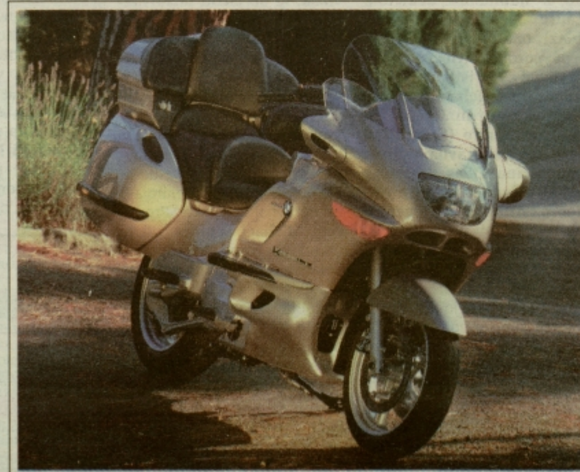
BMW K 1200 LT tehta s 24 litri goriva kar 378 kilogramov! Iz RS-a vzeti šestnajstventilski štirivaljnik je še dovolj močan in prožen (98 KM pri 6.750 v/min in 115 Nm pri 4.750 v/min) za tako breme.
