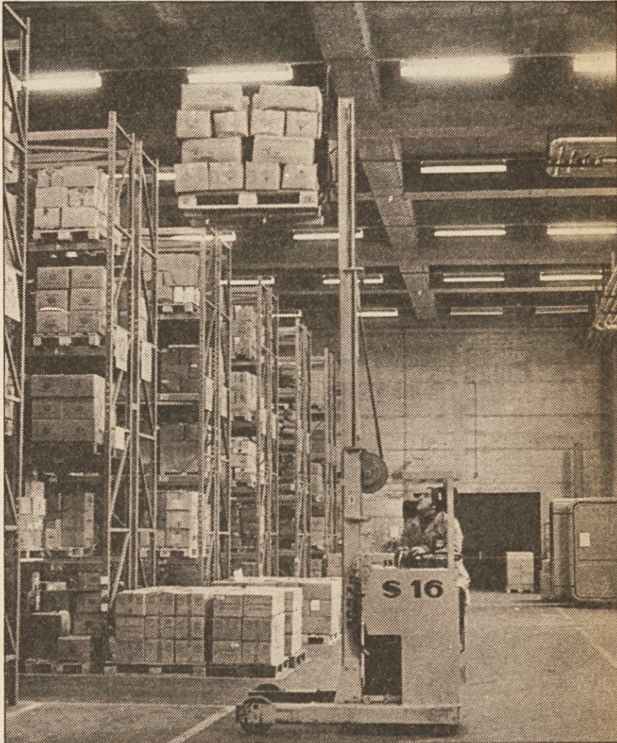
Prototip domačega visokoregalnega viličarja. Dovljenja za uvoz tujih ni, kar zmanjšuje skladiščne zmogljivosti.
