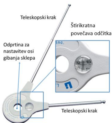
Slika 1: Goniometer Lafayette Gollehon ima raztegljive krake iz kromirane medenine. Kraki se lahko raztegnejo do 71,12 cm pri merjenju OG velikih sklepov in skrčijo do 20,32 cm pri merjenju OG drugih sklepov, razen malih sklepov prstov rok in nog.
