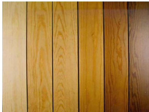
■ Slika 4. Sprememba barve površine borovine z naraščajočo stopnjo modifikacije (Mayes in Oksanen, 2003)
