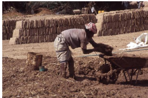
■ Slika 4. Adobe ali čerpič, mešanje mase in vnos slamnatih iveri. Ilovnata masa je učvrščena, oblikovana in na soncu posušena. Yemen (Zupančič, Juvanec, 2005). Les (slamnata vlakna) nastopa kot učvrščevalec, kot armiranje sicer krhkega materiala.
