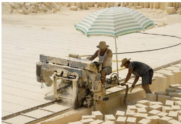
■ Slika 3. Gradnja s kamnom na Malti: žaganje kamna. Mehak kamen izžagajo v bloke, ki jih nato vzdavajo v objekte. Ponekod je kamen tudi povsem nezaščiten in oblikovan kot rob, friz, preklada, konzola, dekor. V tem primeru je to povsem čista montažna gradnja - uporabljana v arhitekturi zadnjih nekaj deset let - brez oblog in skrivanja ter ščitenja konstrukcije. Ne toliko konstrukcija, priprava materiala je kakor pri lesu: žaganje (Malta, otok Gozo, 2007).
