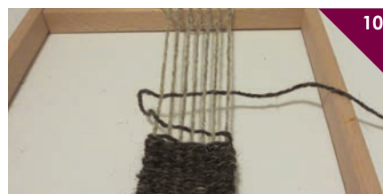
Tkanje z izmeničnim dviganjem lihih in sodih niti ter vnašanjem votka
