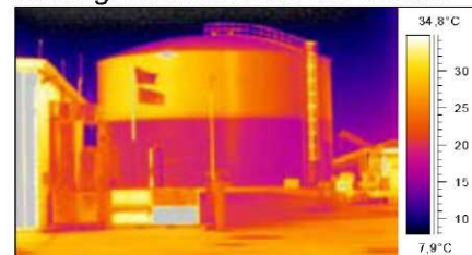
Termogram rezervoarja s tekočino
