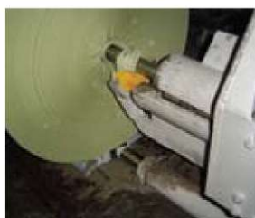
Sproži delovanje hidravličnega bata, ki potisne voziček z zvikom z navijalnega droga.
