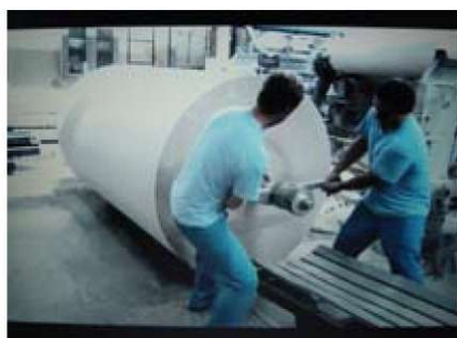
S pomočjo sodelavca izvleče navijalni drog.
