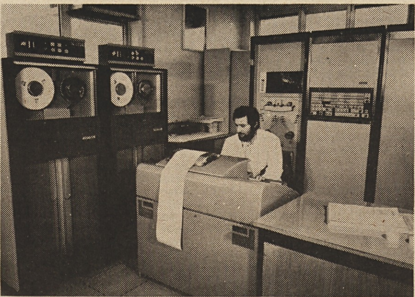
Delo v računskem centru na Laborah na sistemu 3200. Strokovnjak za programsko opremo simulatorja „oživlja“ paket programov, ki bo simuliral delovanje telefonske centrale in akcije naročnikov pri preizkušanju programske opreme za obdelavo pozivov.
