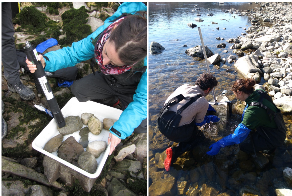
Slika 9. Merjenje fitobentosa z napravo BenthosTorch (levo), ARPA FVG je na vseh štirih vzorčnih mestih izvedla vzorčenje bentoških nevretenčarjev in fitobentosa (desno) (foto: Gabrijelčič E. in Peternel A.). Figure 9. Measurement of phytobenthos with a BenthosTorch (left), ARPA FVG performed sampling of benthic invertebrates and phytobenthos at all four measuring points (right) (Photo: Gabrijelčič E. and Peternel A.).
