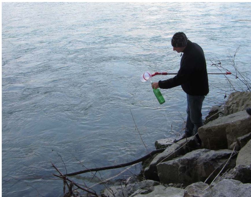
Slika 7. Vzorčenje vode za kemijsko analizo policikličnih aromatskih ogljikovodikov (PAH) (foto: Gabrijelčič E.) Figure 7. Sampling of water for chemical analysis of polycyclic aromatic hydrocarbons (PAH) (Photo: Gabrijelčič E.)
