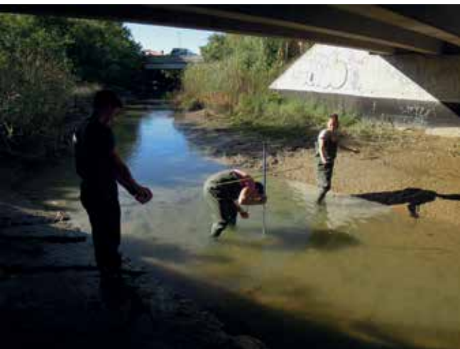
Slika 2: Za meritve uporabimo 20-metrski merilni trak in 1,4-metrsko merilno leto.
