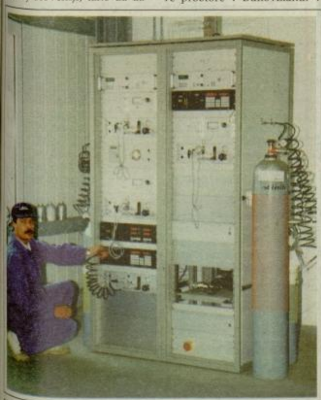
V celjskem Linde plinu imajo edini v Sloveniji analizator plina. Ta jim omogoča merjenje čistosti vseh vrst tehničnih, specialnih in laboratorijskih plinov, takojšnjo kontrolo plinov ter izdajanje certifikatov.
